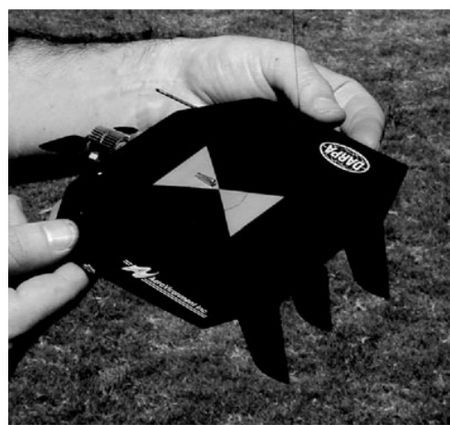
شکل ۹- Black Window اولین ریزپرنده طراحی شده توسط DARPA
