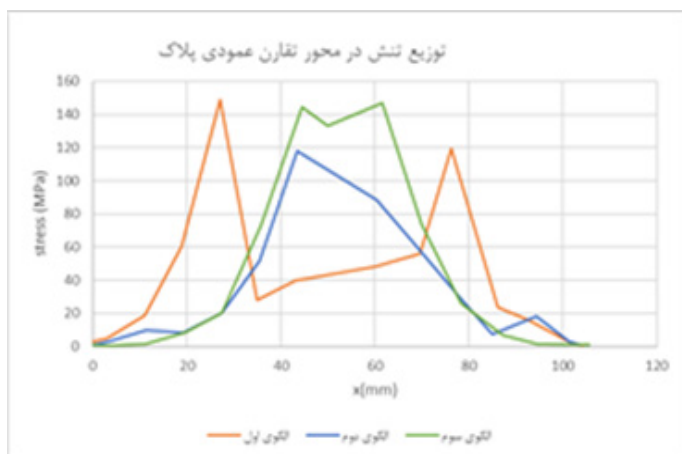
شکل ۷: توزیع تنش در محور تقارن عمودی پلاک در الگوی اول، دوم و سوم
