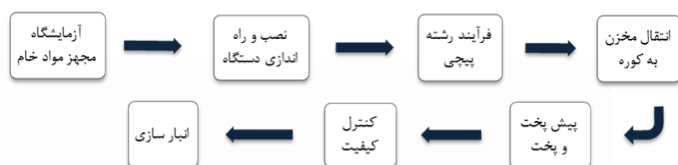
شکل ۴- طرح کلی از تولید یک مخزن کامپوزیتی
