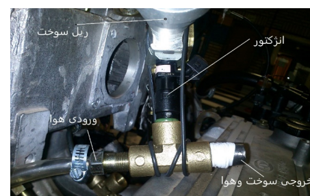
شکل ۶- نحوه اتصال انژکتور به سه راهی اختلاط
